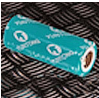
Litium/ion (Li/Fe) cell med nominell spänning 3,3 volt 2300mAh. (diam.26 mm, längd 65 mm). Cellerna kan såväl seriekopplas som parallellkopplas. T.ex. fås ett batteri med 6.6 volt och 4600mAh om 4 celler kopplas ihop.
