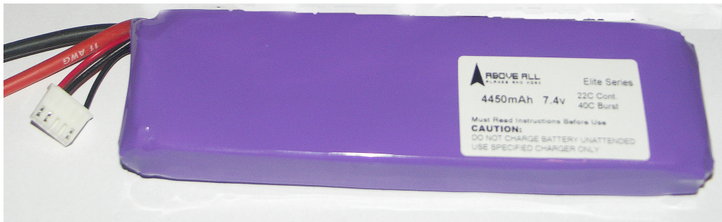
Litium/polymer batteri 7,4 volt (2 celler) 4450 mAh. (160 x 46 x 16 mm)
